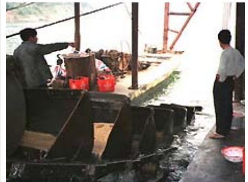
船に取り付けられたチェーンバケットで川砂を採取
