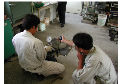
軽量コンクリートの空気量測定
